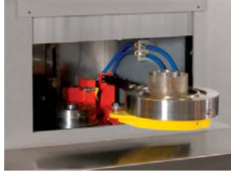
Döner kol, yanma/çapak alma odası yükleme ve boşaltması için uygun maliyetli bir seçenektir. Photo: Kennametal Extrude Hone
