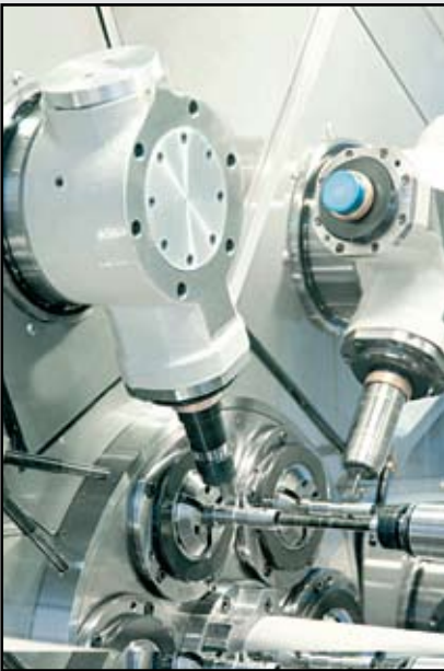
Termo simetrik yapı sayesinde tekrarlanabilir işlemler garanti edilebilmektedir.
