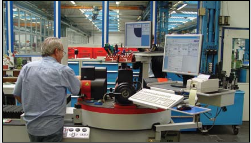
Üretim alanındaki tipik bir önayarlama merkezi. TDM takım setup cihazını gerekli verileri sağlamaktadır.
