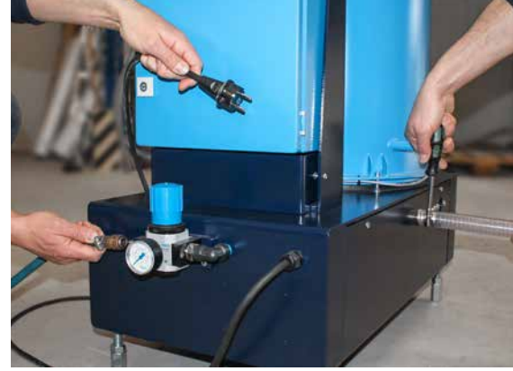
Basıncı hava, elektrik ve besleme hattı bağlantıları
